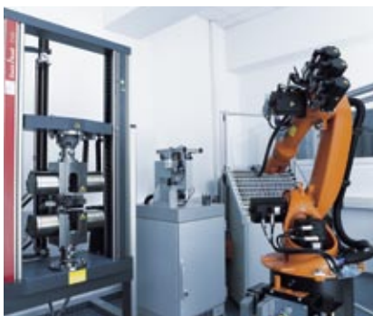
Automatische Zugprüfung mit Roboter
