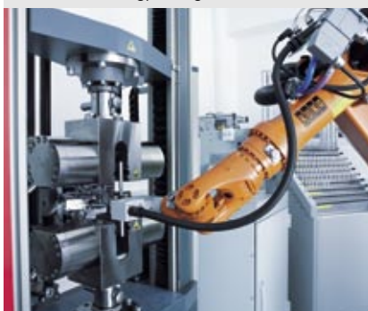
Automatische Zugprüfung mit Roboter
